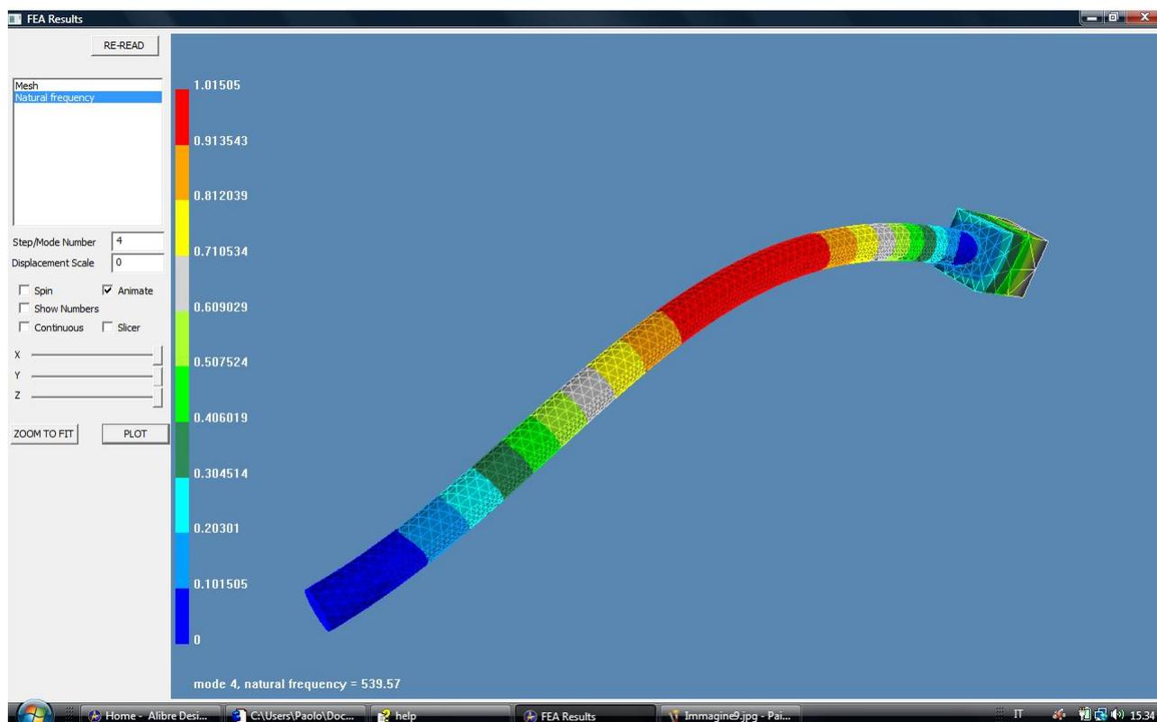
Fig. 10 – Scegliamo il quarto modo di vibrare indicando 4 in *Step/Mode Number*.
