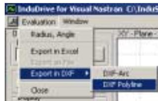
Per un controllo del transfer angle e del bending radius, attivare la prima voce di menù [Radius, Angle]:
