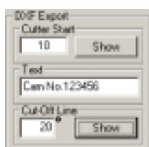
Altre informazioni aggiuntive, quali ad esempio il punto di partenza per la macchina a controllo numerico [Cutter Start], un testo descrittivo o il taglio della camma [Cut-Off Line] possono infatti essere inseriti nel disegno DXF.
